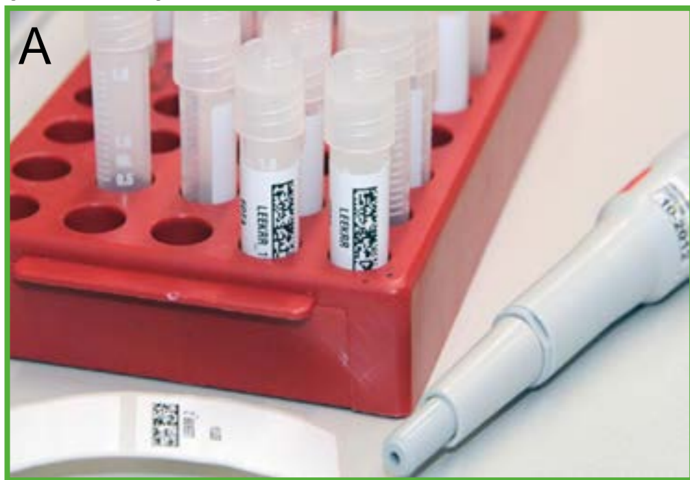
Abbildung 1: (A) Etikettiertes Kryo-Röhrchen (B) Lagerung bei -80°C (C) Probendokumentation im BIMS (D) Teilautomatischer Capper/ Decapper (E) SBS-Rack mit 2d-codierten Tubes
