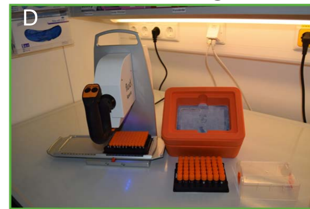
Abbildung 1: (A) Etikettiertes Kryo-Röhrchen (B) Lagerung bei -80°C (C) Probendokumentation im BIMS (D) Teilautomatischer Capper/ Decapper (E) SBS-Rack mit 2d-codierten Tubes
